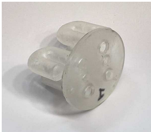
Figura 2 – a) Multirisonatore di Helmholtz a collo integrato (NEHR). B) Multirisonatore basato su Canali Fabry-Pérot (Canali FP).
