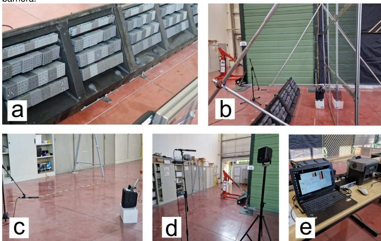
Figura 1; a) particolare di una barriera bassa con metamateriale installato; b) configurazione di misura con schermo riflettente (simulazione sagoma del treno); c) microfono e sorgente sonora (misura in campo libero bassa); d) microfono e sorgente sonora (misura in campo libero alta); e) sistema di misura portatile: PC, interfaccia audio e Power Station.
