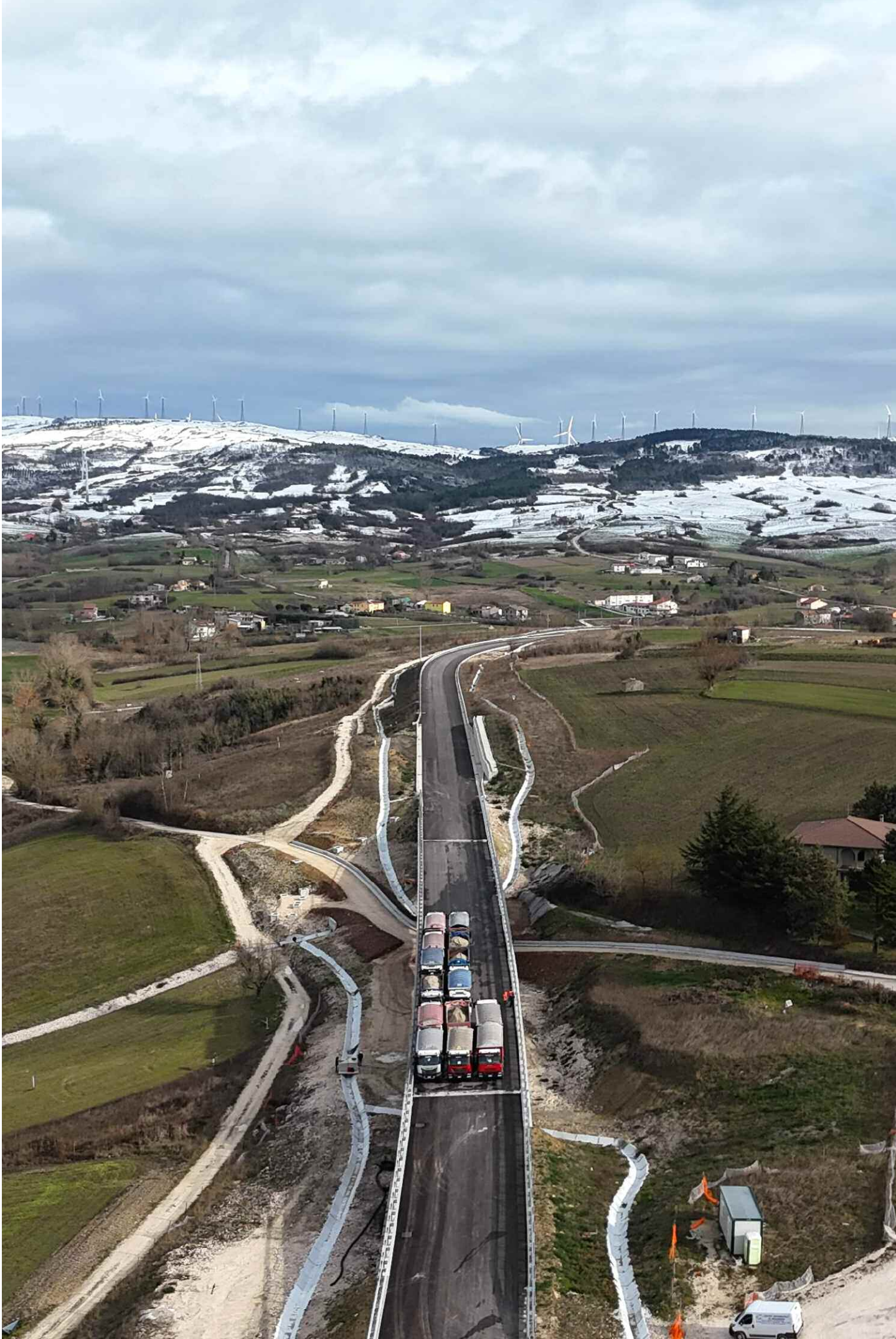
CAMPANIA - STRADA STATALE 212 “DELLA VAL FORTORE”, PROVE DI CARICO SUI VIADOTTI DELLA VARIANTE DI SAN MARCO DEI CAVOTI
