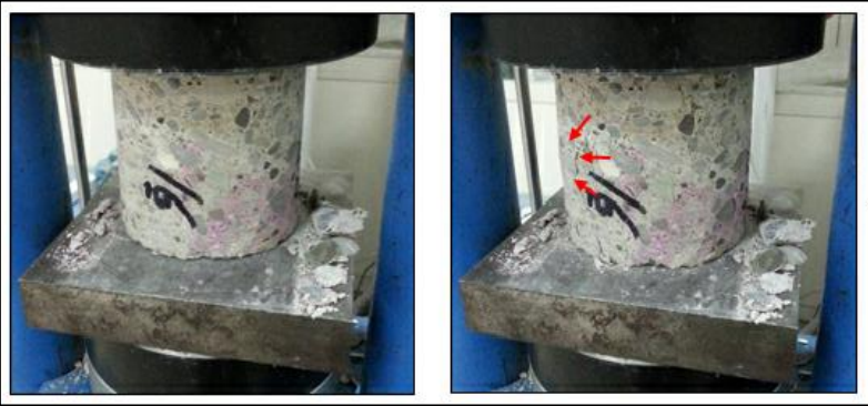
Figura 9. Prova di rottura su carota
