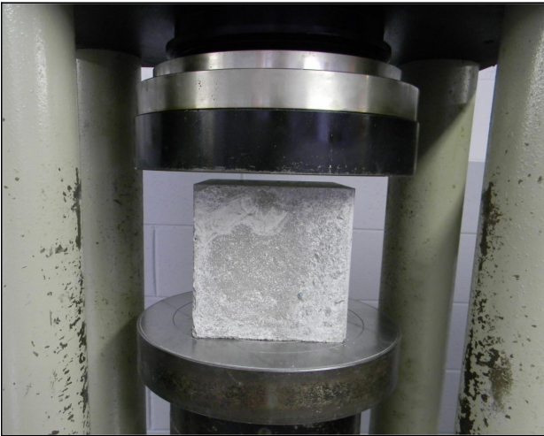
Figura 8. Prova di rottura su cubo
