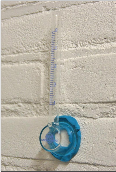
Figura 6. Prova di Karsten
