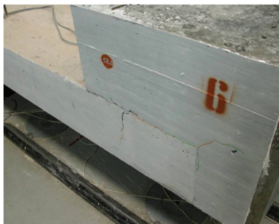
Figura 25 - Quadro fessurativo tipo sulle due superfici del cordolo
