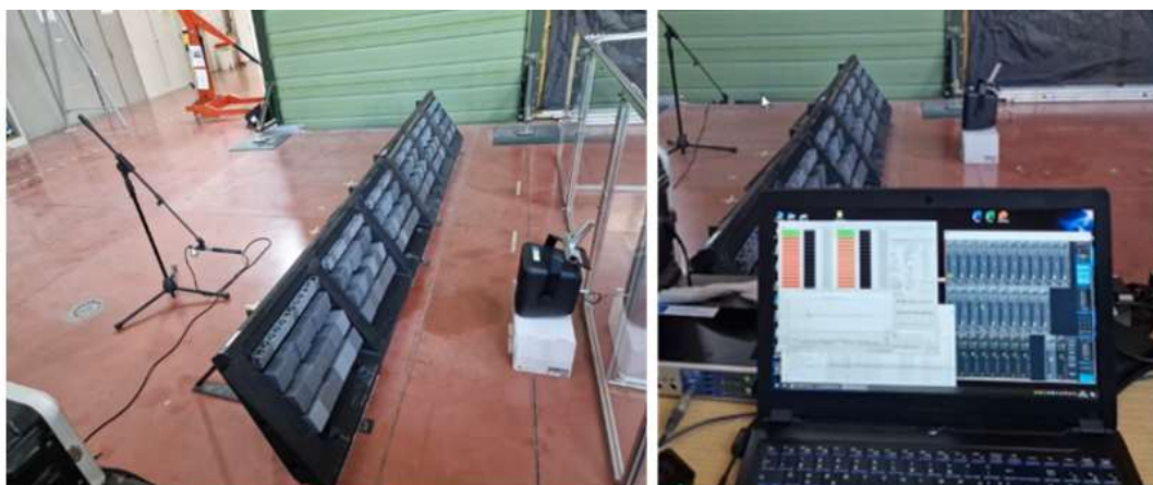
Figura 2 – A sinistra, il prototipo della barriera bassa integrata con gli elementi in metamateriale. A destra, l'utilizzo del prototipo per la messa a punto del sistema di misura.
