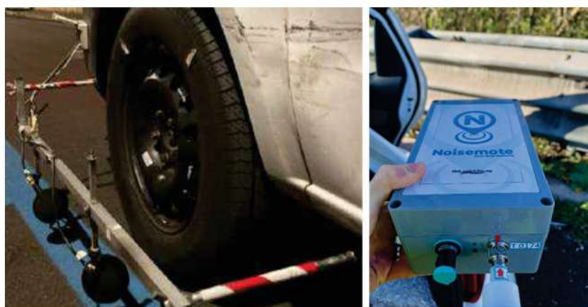
Figura 3 – A sinistra, la strumentazione utilizzata per le misure CPX. A destra, il dispositivo sviluppato durante il progetto DYNAMAP installato nell'area pilota.
