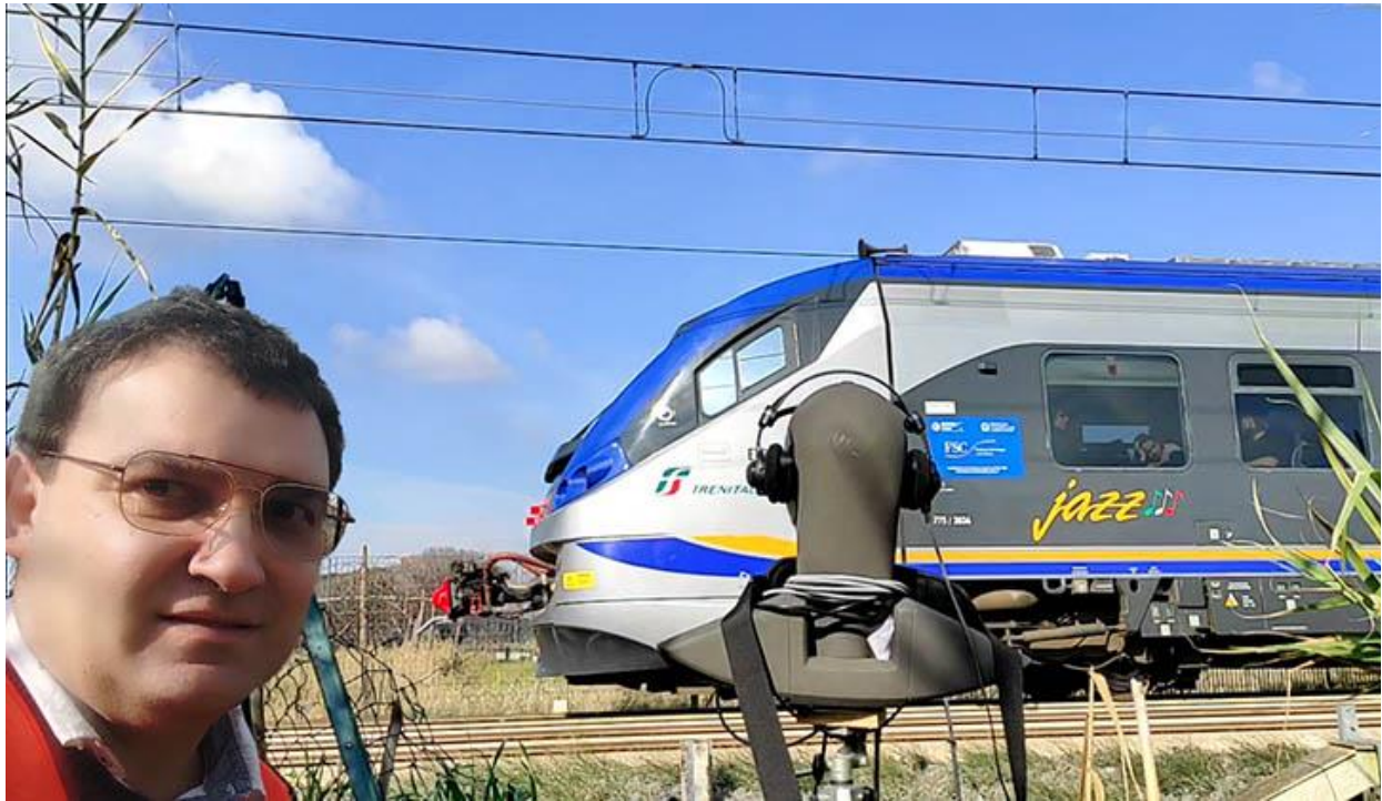
Figura 1 - Registrazione binaurale tramite testa acustica
